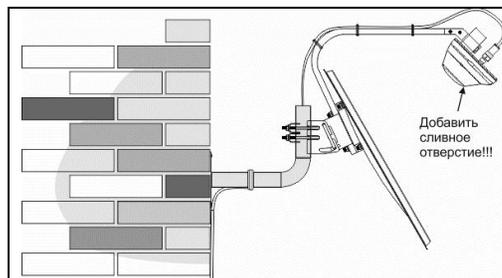
Мы не рекомендуем устанавливать облучатель выше основной части зеркала (как на рисунке слева), так как это может способствовать попаданию воды внутрь облучателя и выходу облучателя из строя. Если вы все же решили устанавливать именно так, то необходимо добавить сливное отверстие в самой нижней точке корпуса облучателя.
