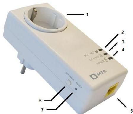
1. **Встроенная розетка 16А 250В** позволяет Вам подключить к адаптеру другие устройства. При этом адаптер фильтрует помехи от подключенного устройства, которые могут помешать его работе;
